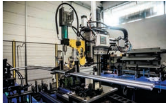
Robot di montaggio strutture metalliche porte sezionali. Robot for assembling metal structures for sectional doors.
